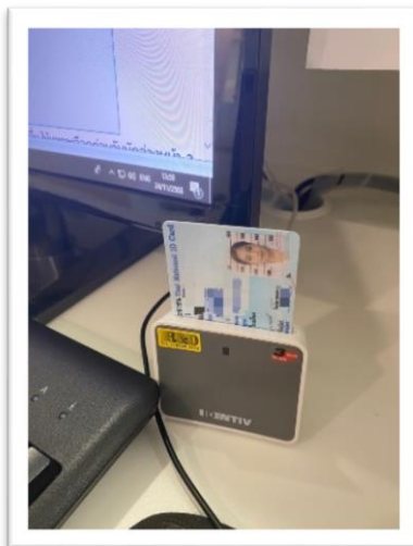
รูปที่ 2 เลียบบัตรประชาชนเข้าเครื่องอ่านบัตรประชาชน
