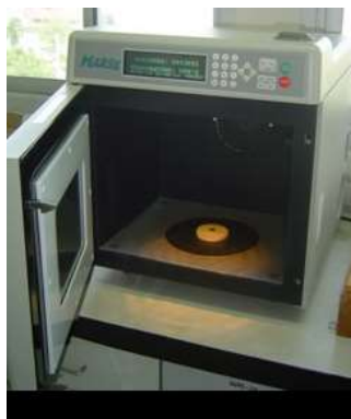
ภาพ 5.17 เครื่องย่อยสารที่ปล่อยไอกรดอันตราย
