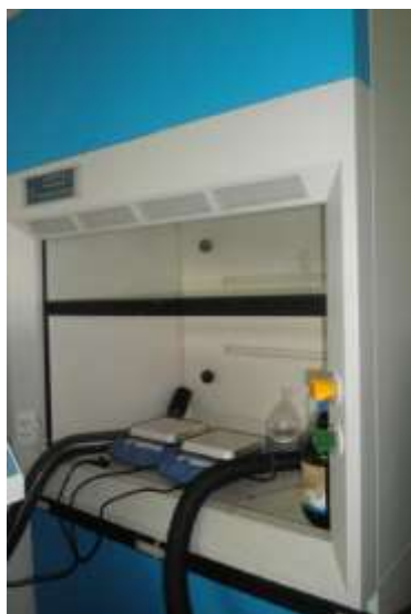
ภาพ 7.1 ตู้ดูดควัน ดูดไอของสารเคมีปล่อยออกสู่สิ่งแวดล้อม
