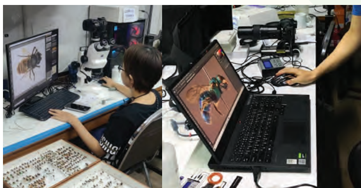
ภาพที่ 4 การถ่ายภาพทางวิทยาศาสตร์ของตัวอย่างผึ้งในประเทศไทยโดยใช้กล้องสเตอริโอ ZEISS Discovery.v8 ติดหัวกล้อง Canon EOS 90D และ ระบบรางของ Cognisys StackShot Macro Rail ด้วยกล้อง Canon MP-E 65mm f/2.8 1-5x Macro Lens ภาพจะถูกถ่ายไว้สามระนาบของตัวอย่าง โดยแต่ละภาพที่ได้จะใช้การ Stack Shots เพื่อให้ได้ภาพที่มีความชัดเจนมากที่สุด และนำมาตัดฉากหลังด้วยโปรแกรม Adobe Illustrator และ Photoshop
