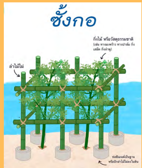
ภาพที่ 2 แบบจำลองบ้านปลาแบบซั้งกอ
